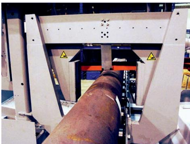
Специальные зажимные тиски для поперечной центровки железнодорожной оси. Реализовано на предприятии «Рославльский вагоноремонтный завод».
