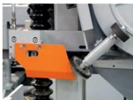
привод при помощи фрикционного диска, для серии eco-line
