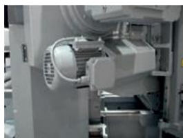
привод при помощи отдельного двигателя, вращение синхронно с главным приводом.
