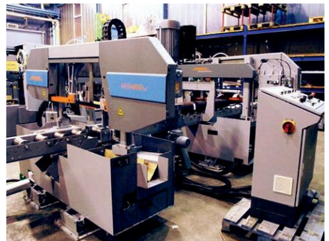
Тандем из двух станков МЕВА для торцовки с обеих сторон железнодорожной оси. Ось центруется в продольном положении автоматически, что позволяет получить требуемый размер.
